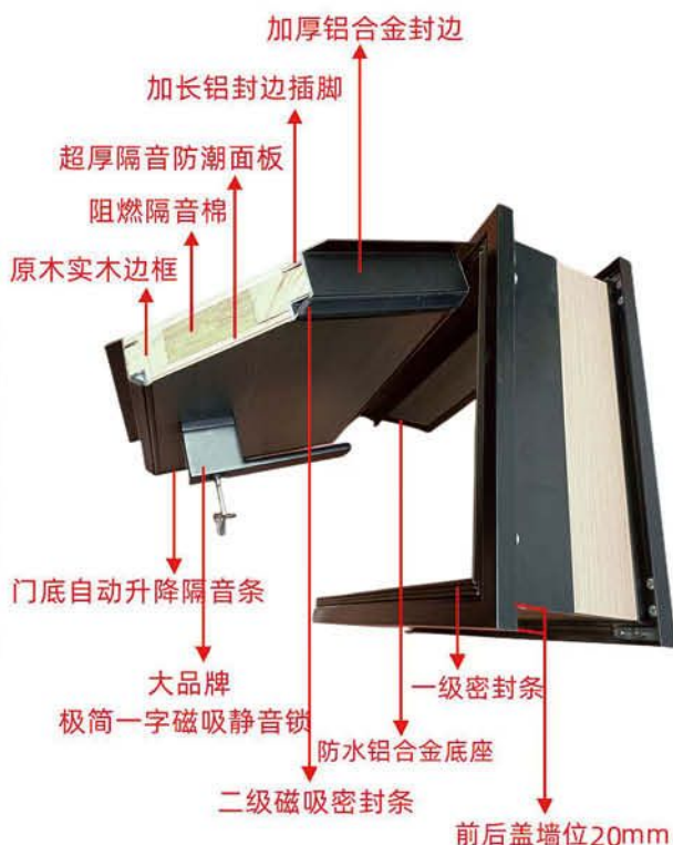
声学静音隔音铝木门解剖图
